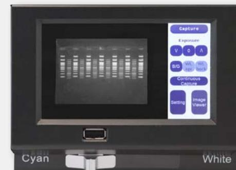
Das große Touchscreen-Display und die integrierte Software ermöglichen eine sehr einfache Navigation und Bilderfassung.
